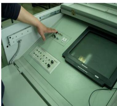
5) 按讲台内功能面板上的计算机和投影机开关按钮（稍等，投影机点亮、计算机进入开机菜单界面）。话筒在钥匙包内。
