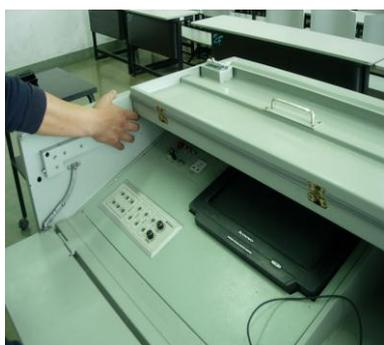
4) 如图用手按下插销中间的圆柱，使插入铁皮圆空的插杆弹开，接着把移门向前推到底。
