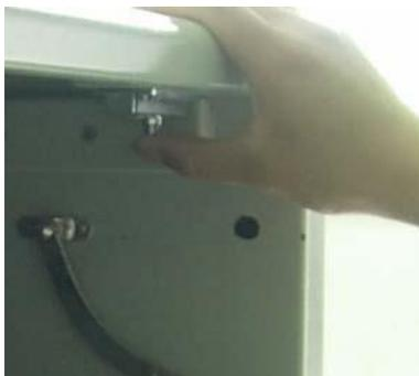
2) 如图用手按下插销中间的圆柱，使插入圆空的插杆弹开。（两边位置）
