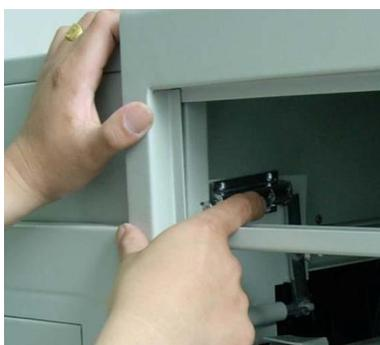
2) 如有插销，用右手按下插销中间的圆柱，使顶住铁框的销子弹开（延长校区跳过此步）。
