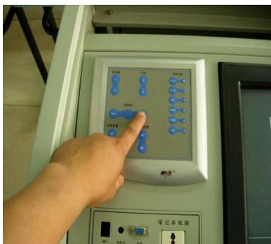
1) 使用中不要随意按面板上的投影机开关键,以免灯泡炸裂。
