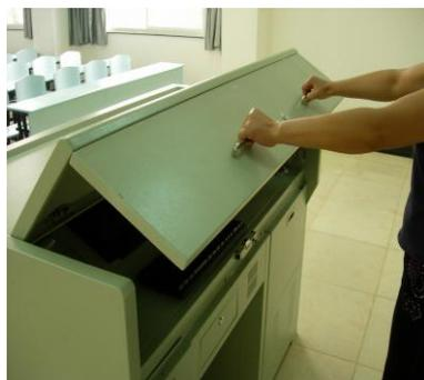
5) 向后、向下翻到底，将拉门对准锁孔和槽边。此时投影机会自动熄灭、部分讲台内的电脑自动关机。
