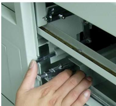
5) 如有插销，左手向左按住移门，右手按图推入顶杆销，使插销销住移门（延长校区跳过此步）。
