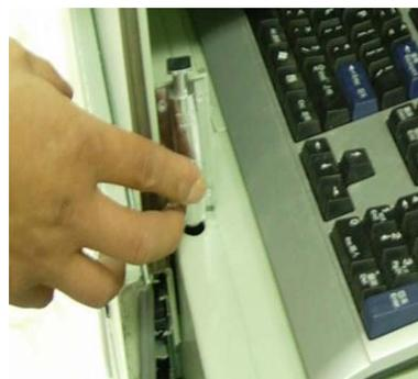
3) 如有插销，如图按下插销中间的圆柱，使插入铁皮圆空的插销向上弹开。
